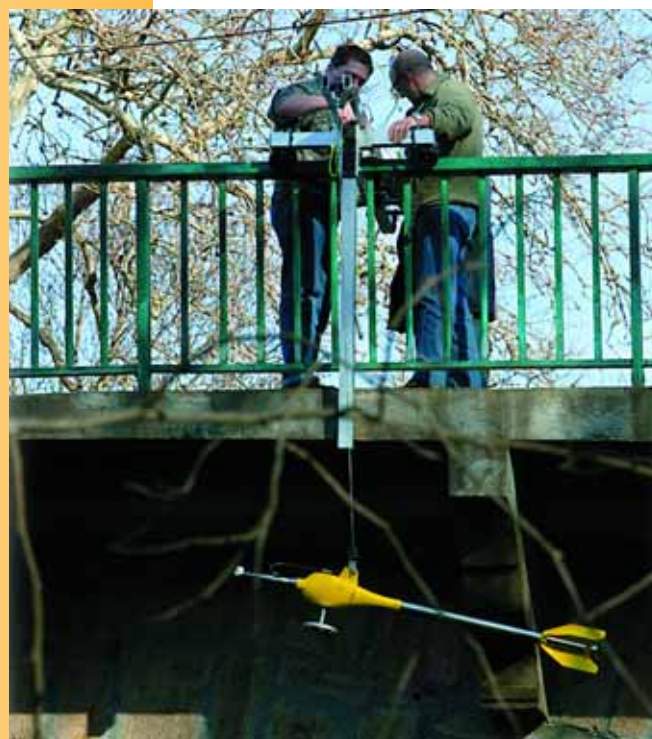
Mise en place du «saumon» dans le cours d'eau.
